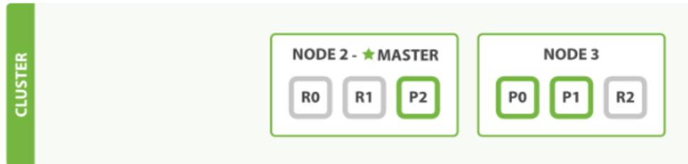
Abbildung 6: Cluster nach Ausfall eines Nodes
