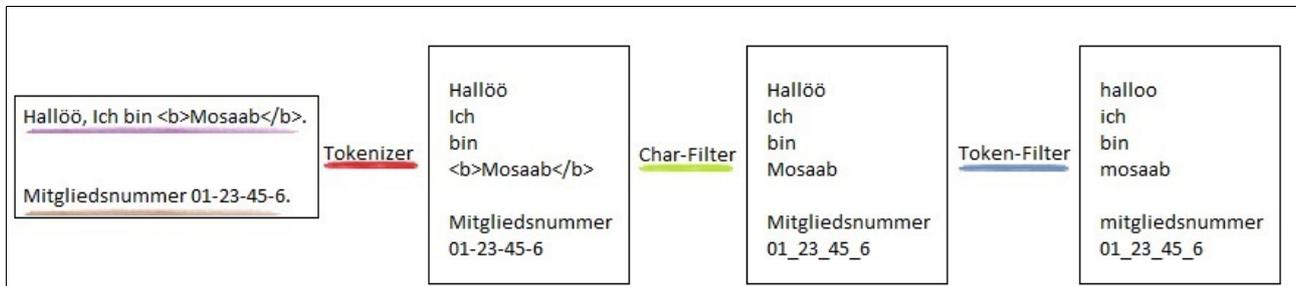
Abbildung 1: Benutzerdefinierter Analyzer aus Tokenizer, Char-Filter und Token-Filter
