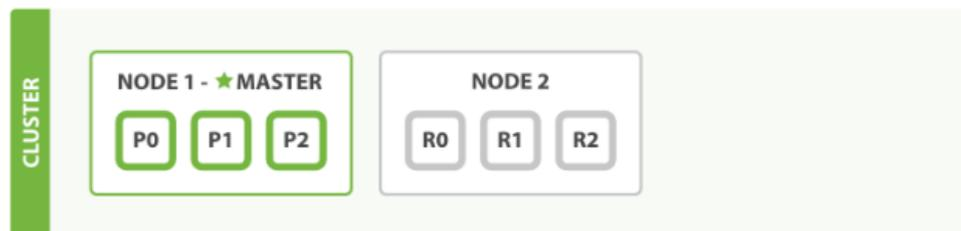
Abbildung 4: Cluster mit zwei Nodes - alle primären und Replica-Shards werden zugewiesen
