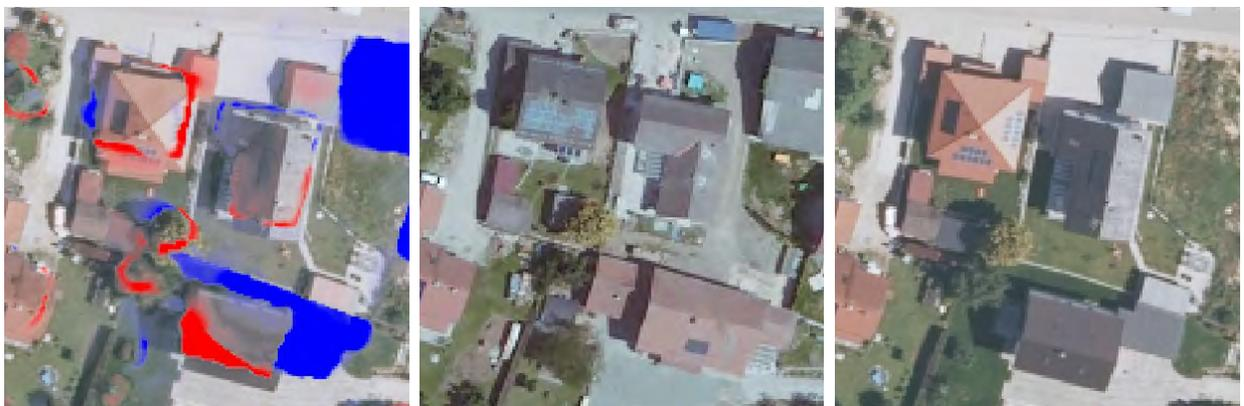
**Abb. 3-11:** Abriss & Neubau; links tDOM, in der Mitte 2013, recht 2016
