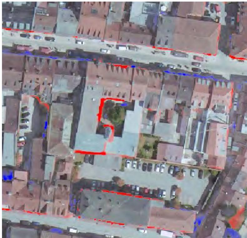
**Abb. 2-22:** Auswirkung des Vorhangeffektes auf das tDOM: falsche Höhenunterschiede an Gebäudekanten
