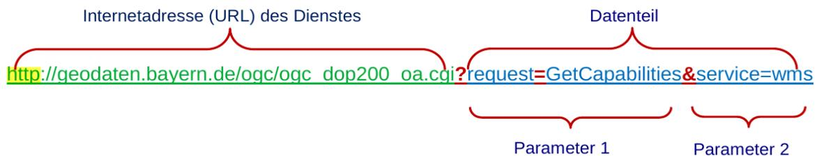
**Abbildung 1: Aufbau der HTTP-Anfrage an einen WMS**
