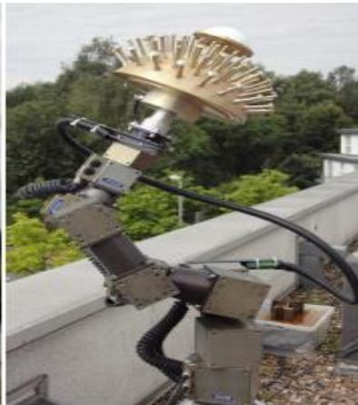
Abb. 7: Geo++ Roboter mit TPSPN\_A5 NONE Antenne.
