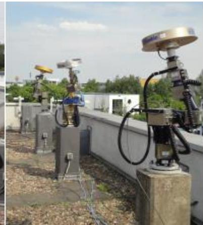
Abb. 8: Drei Roboter Testantennen bei Geo++ in Garbsen.
