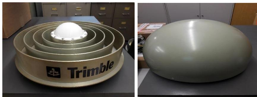
Abb. 18: Links: Trimble Chokering ohne Radome. Rechts: Trimble Chokering mit Radome.
