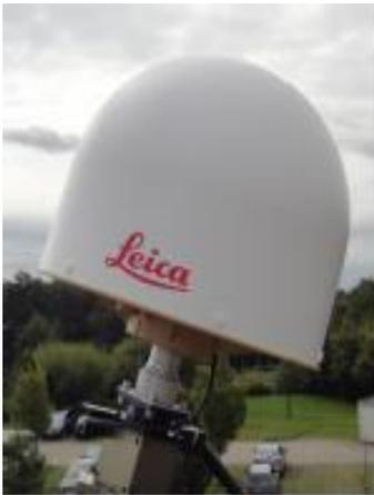
Abb. 6: Geo++ Roboter mit Leica AR.25.R4 Antenne und Radome.
