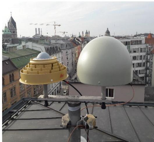
Abb. 15: am 20.02.2019: Links auf dem Südpfeiler die Leica AR. 25 und rechts auf dem Nordpfeiler die Trimble Chokering Antenne.
