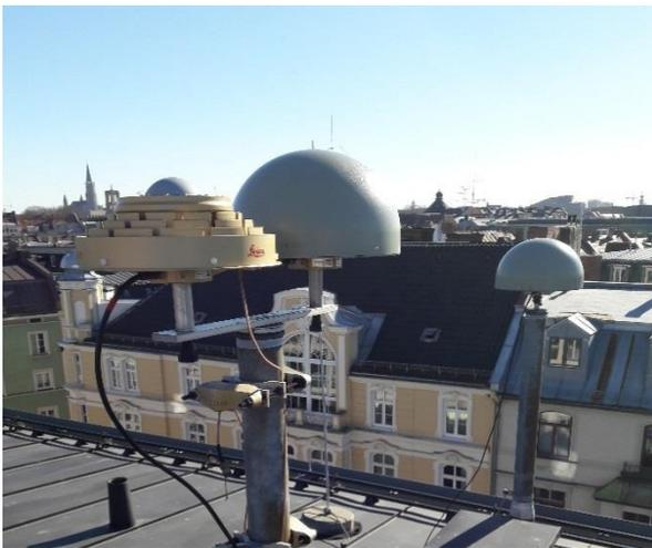
Abb. 14: am 19.02.2019: Links auf dem Nordpfeiler die Leica AR. 25 und direkt rechts davon auf dem Südpfeiler die Trimble Chokering Antenne. Weiter rechtsunten ist die Referenzstation von München sichtbar.
