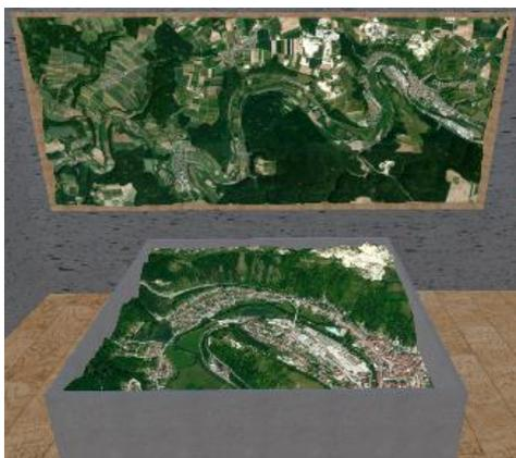
Abbildung 14: DGM 1m mit einem DOP als Oberfläche
