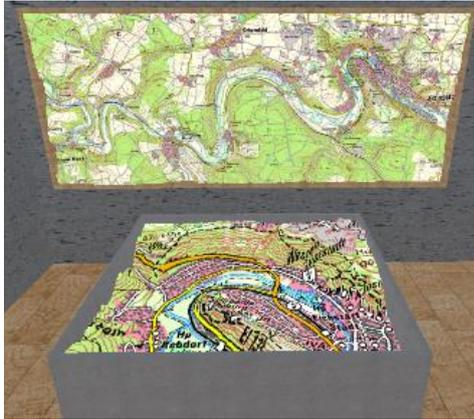
Abbildung 16: DGM 1m mit einer TK50 als Oberfläche
